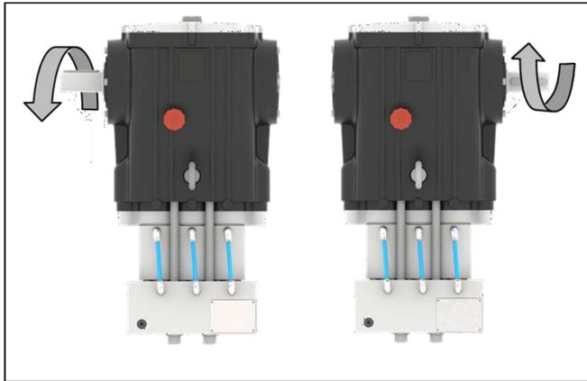
Figure 16 : Sens de rotation standard de l'entraînement pour la pompe droite et gauche
